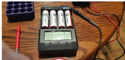
Vor dem 30-tägigen Einlagern, wird nochmals die Spannung mit dem Multimeter gemessen und dokumentiert. Nach den 30 Tagen wird dann wiederum die Spannung gemessen und dokumentiert.
