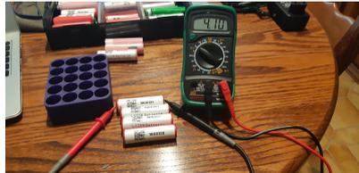
Dannach wird unser Zellen Testgerät benutzt, um die Zellen zu laden. Dafür wird die Option Refresh verwenden, um die Zellen mehrmals zu be- und entladen. Ist dies vollendet, erscheint auf dem Display FULL. Jetzt kann man direkt die Kapazität und den Innenwiderstand messen und dokumentieren.
