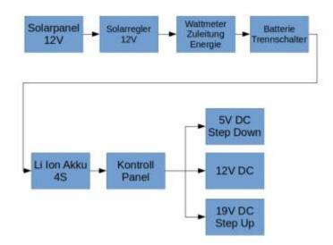
Mittels Solar Panel (oder Windrad) wird Energie gesammelt und über den Solarregler (für 12V) weitergeleitet.
