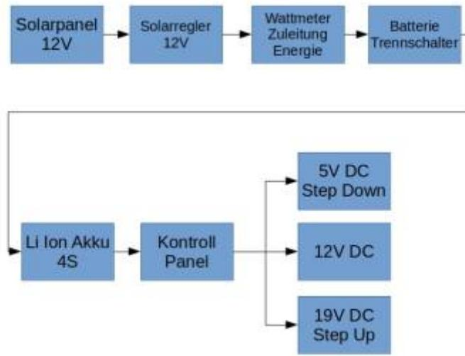
Mittels Solar Panel (oder Windrad) wird Energie gesammelt und über den Solarregler (für 12V) weitergeleitet. Ein Wattmeter misst dabei die gewonnene Energie die an den Li-Ion Akku über eine BMS eingespeist wird.
