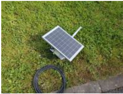
10W Solarmodul & 6dbi Antenn mat integréiertem Bandpassfilter
