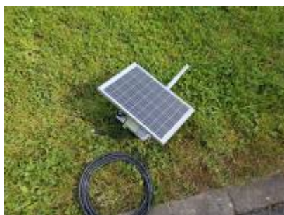
10W Solarmodul & 6dbi Antenn mat integréiertem Bandpassfilter
