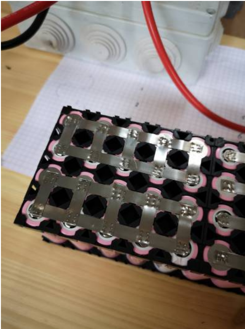
Nahaufnahme der Brücken
